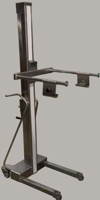
Levage d'outillage machine Tool lifting
